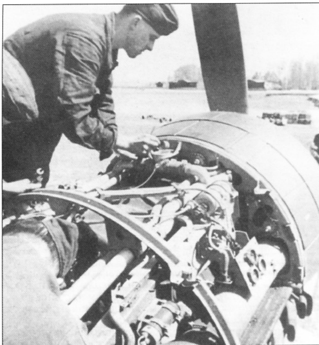
Техническое обслуживание двигателя JuMo 211 (Ju 88A)
