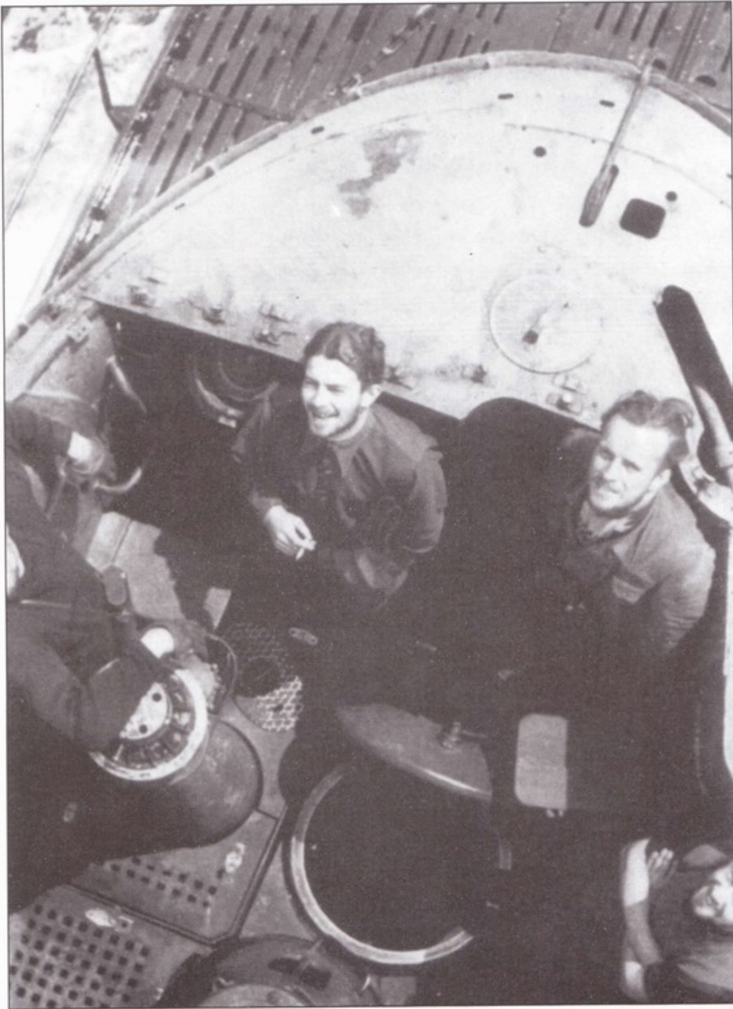
Вид сверху на мостик подводной лодки IX серии. Обратите внимание на совсем небольшой диаметр рубочного люка. Через этот люк в случае срочного погружения нескольким морякам необходимо протиснуться всего за несколько секунд. Рука одного подводника покоится на тумбе, предназначенной для бинокля UZO.
