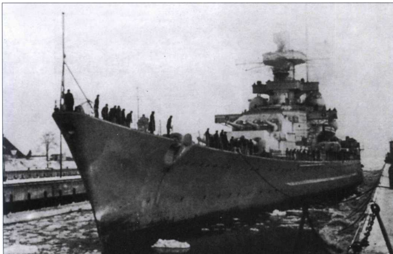
«Шарнхорст» в доке Вильгельмсхафена, начало 1939 г. Клиперный нос увеличил длину корабля на 5,1 м до 234,9 м. 105-мм зенитные орудия «Гнейзенау».
