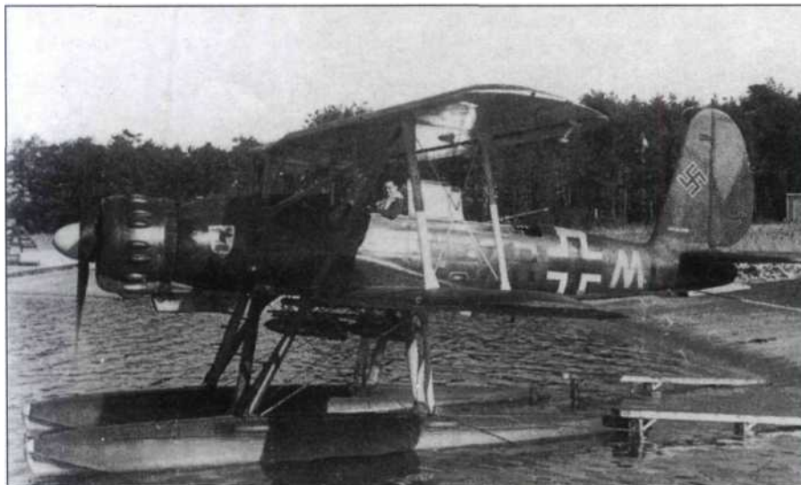
Подобно He-114, гидроплан Ar-95 не задержался на катапультах германских кораблей. Характеристики гидросамолета не удовлетворили заказчика. На снимке - Ar-95A-1 (7R+ML) из 3-го штафеля 125-й морской разведывательной авиагруппы, Балтика, 1941 г.
