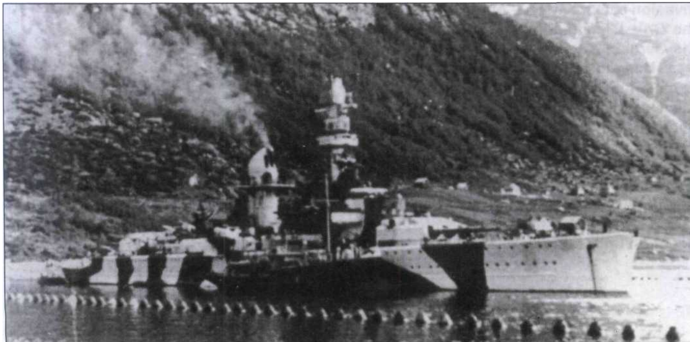
В начале лета 1942 г. «Лютов» находился в Нарвике, в тот период корабль имел камуфляжную окраску из полос темно-серого цвета по светло-серому фону. На больших дистанциях камуфляжная окраска сливалась в однотонный средне-серый цвет, в результате чего корабль терялся на фоне свинцовых небес севера. На коротких дистанциях «разрушающий» камуфляж затруднял противнику точное определение расстояния до корабля. На «Лютове» установлен заостренный нос «клиперного» типа.
