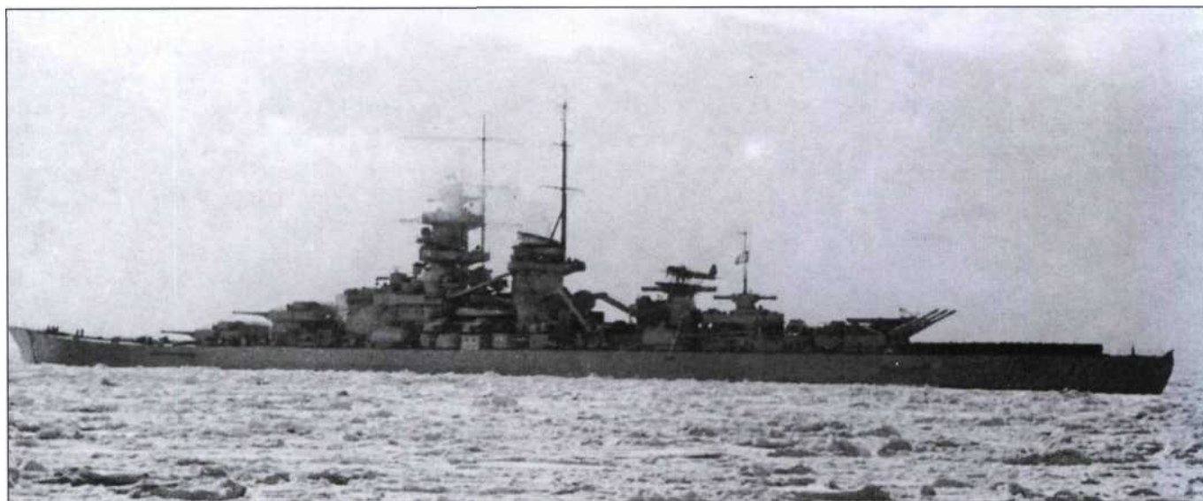
«Гнейзенау» во льдах, операция «Нордмарк», февраль 1940 г. На катапульте установлен гидросамолет Арадо Ar-196, катапульты на башне пустая. В 1942 г. катапульту с кормовой башни сняли. Башенные катапульты на «Шарнхорстах» практически не использовались.
