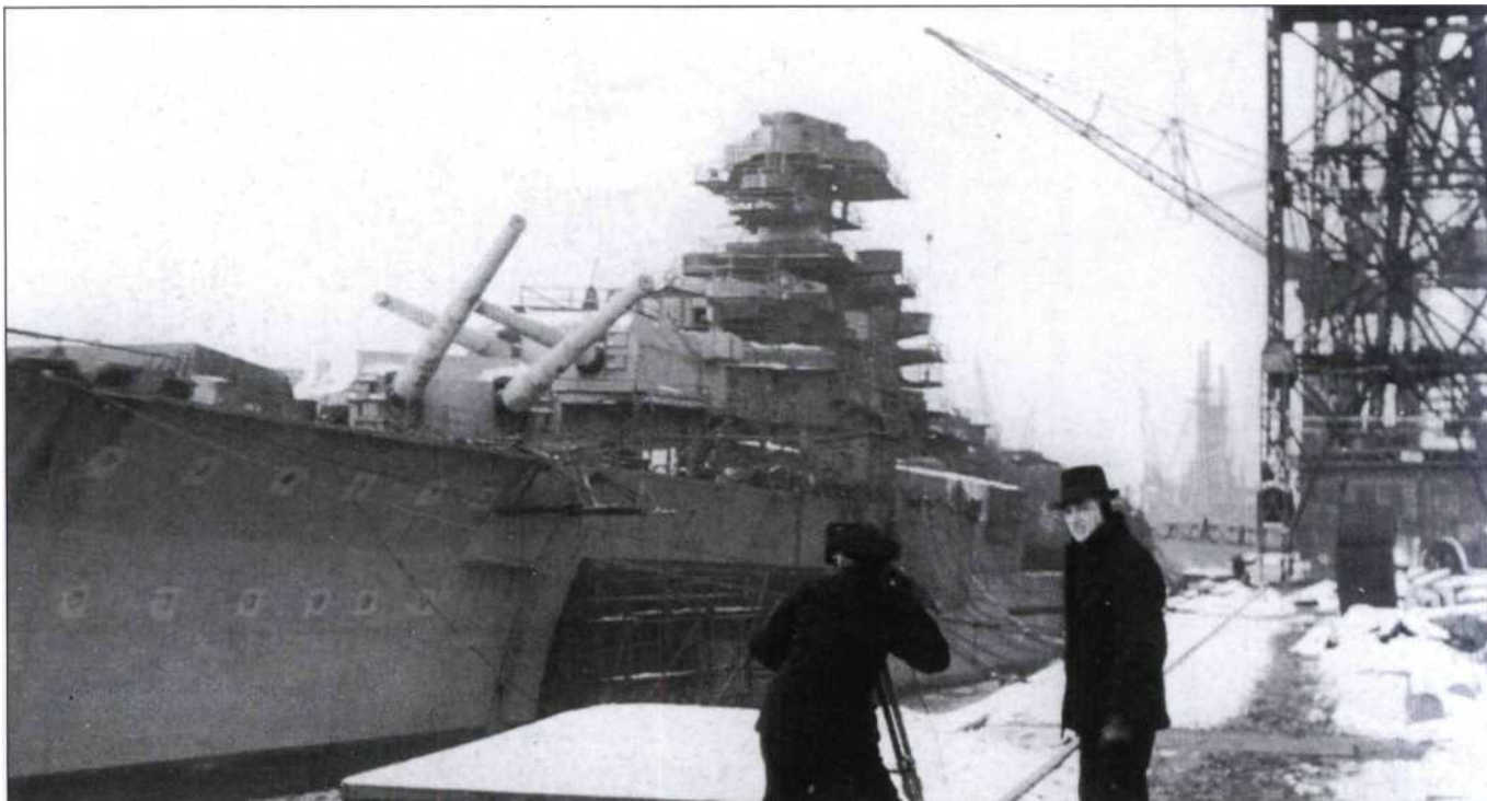
Достройка «Бисмарка» у стенки завода Блом унд Фосс в Гамбурге продолжалась всю зиму 1939 -1940 г.г. В носовых башнях главного калибра установлены 380-мм орудия SK C/34 с дальностью стрельбы 19,85 морских миль (36,8 км).
