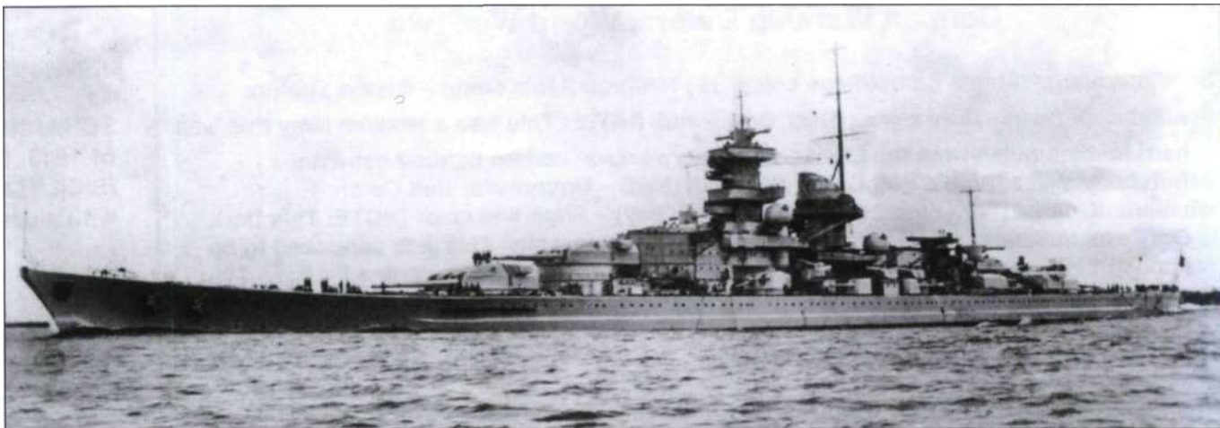
Пропагандистский плакат с фотографией «Гнейзенау». В конце 1938 г. на «Гнейзенау» поставили клипперный нос и козырек на дымовой трубе. В отличие от «Шарнхорста», грот-мачта «Гнейзенау» стояла сразу за дымовой трубой.
