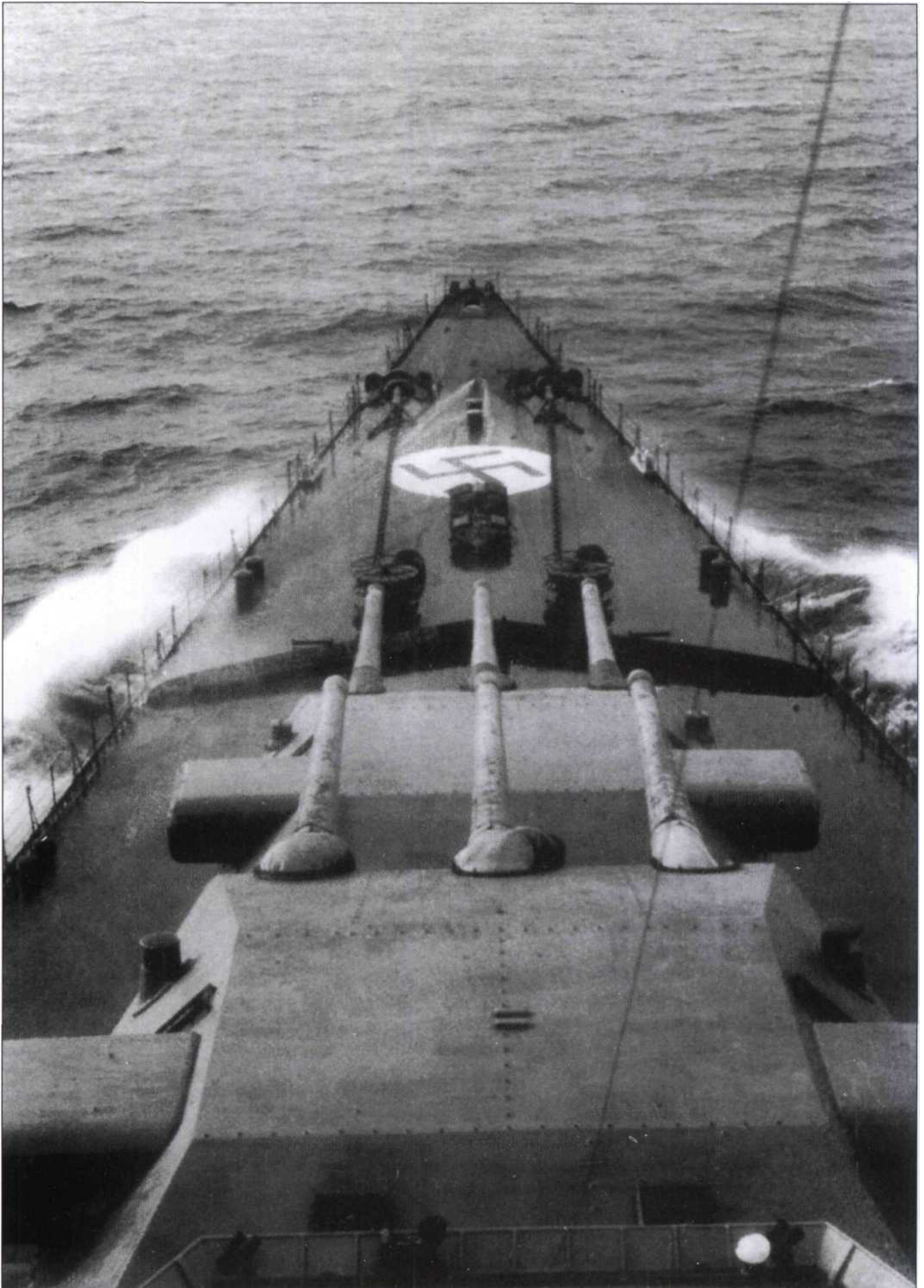
Носовая оконечность «Гнейзенау», операция «Джюно», июнь 1940 г. Верхние части башен главного калибра окрашены в темно-серый цвет, белые круги на башнях закрасены. Теперь в качестве символа быстрого опознавания с воздуха используется нарисованный на палубе нацистский флаг. На черно-белом снимке красный фон «флага» сливается с темно-серой палубой.
