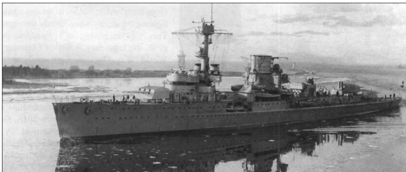
По единственной дымовой трубе «Лейпциг» легко отличим от своих предшественников - К-крейсеров. Снимок выполнен в Свиномюнде, Германия, до ремонта крейсера в 1934 г., когда катапульты перенесли вперед трубы. Некая конструкция над носовой надстройкой крейсера является просто башней на берегу.
