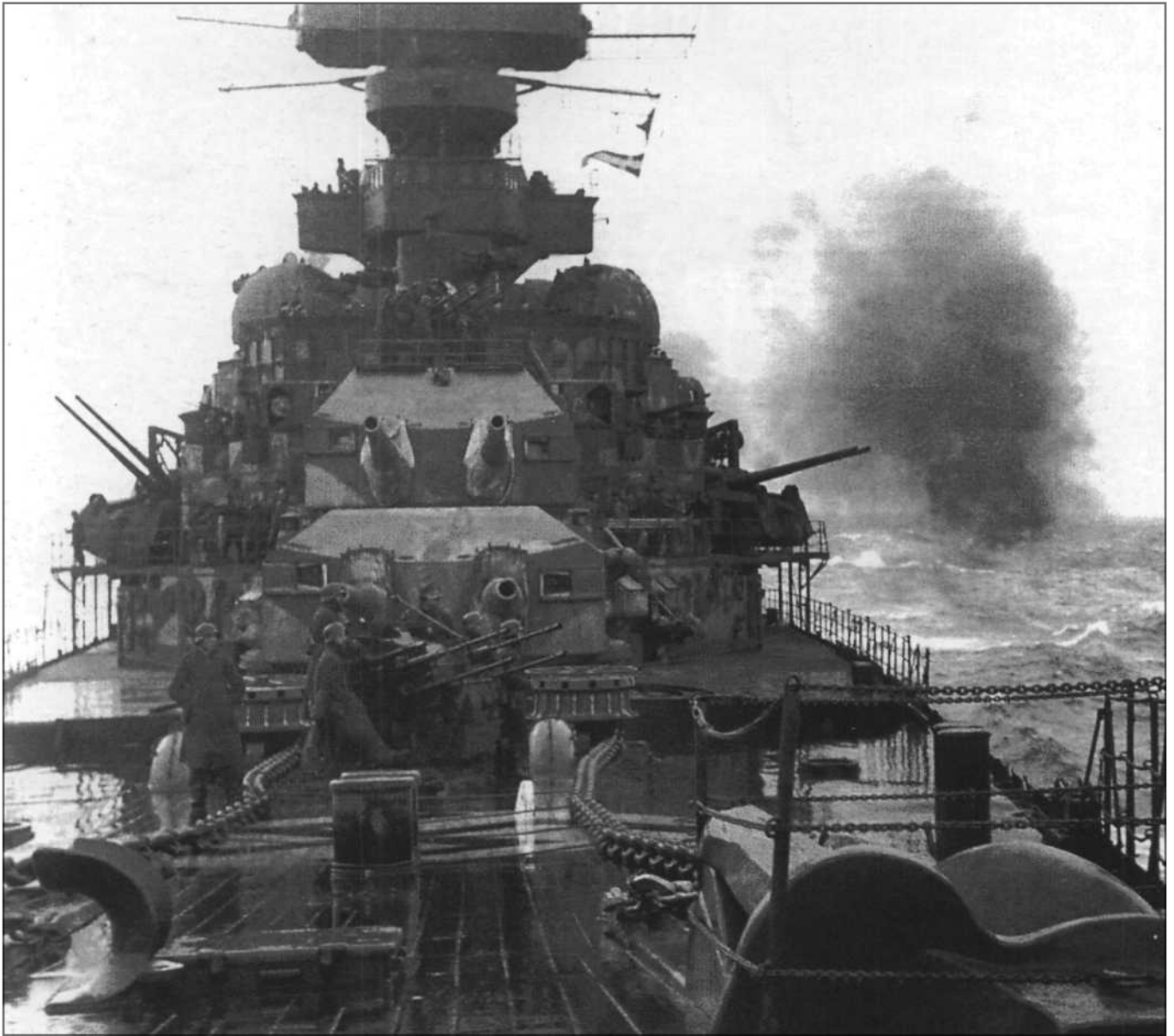
Тяжелые зенитные орудия левого борта крейсера «Принц Евгений» ведут огонь по британским самолетам, Ла-Манш, операция «Церберус», 12 февраля 1942 г. Спаренные 105-мм зенитные установки фланкировали носовую надстройку крейсера, выше 105-мм пушек стояли 37-мм зенитки. На время перехода Ла-Маншем на крейсер поставили пять армейских счетверенных 20-мм зенитных автомата, в кадр попали два из них, один установлен перед башнями главного калибра, другой - на крыше башни «В» главного калибра.
