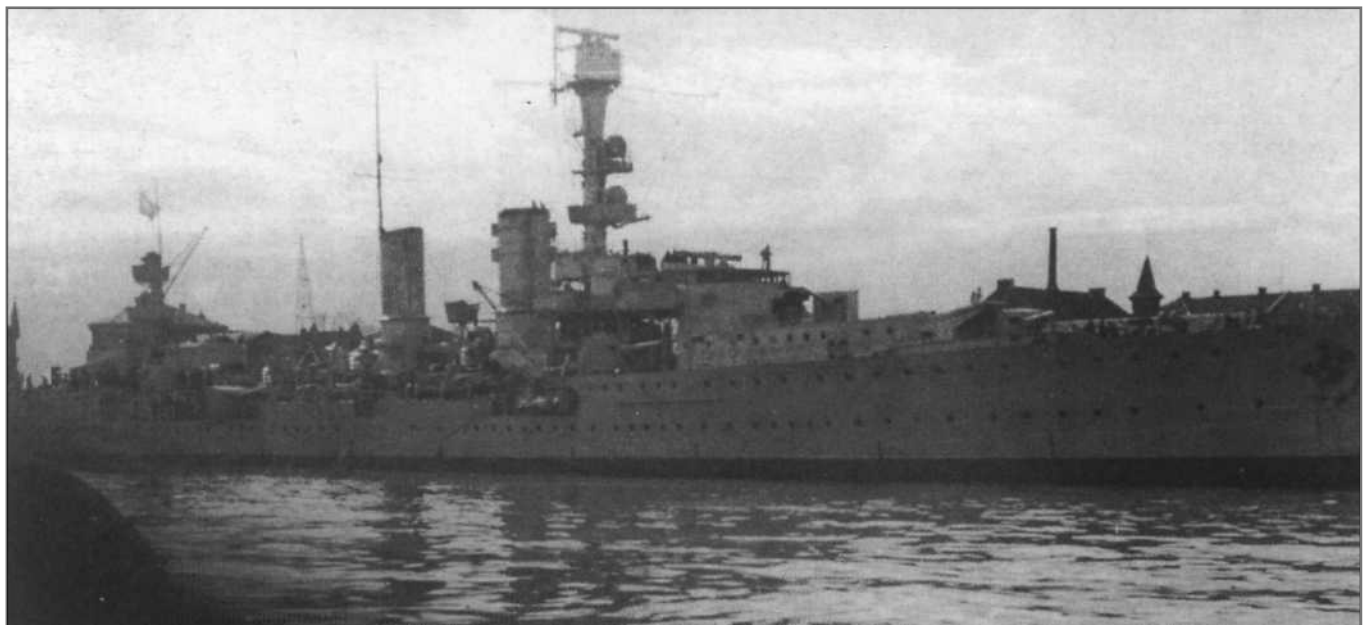
«Эмден» в первые недели Второй мировой войны. Железный крест и геральдика с носовой части корпуса были удалены сразу после начала войны. Во время ремонта в середине сентября 1939 г. на корабле были установлены кабели системы размагничивания. В середине 1938 г. у корабля заменили форштевень, поставив вместо скругленного более прямой.
