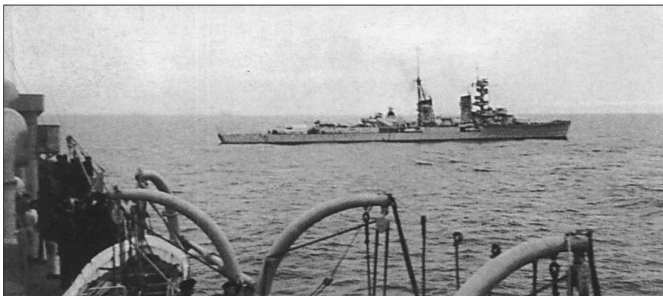
Редкий снимок «Карлсруэ», сделанный после ремонта 1939 г. незадолго до гибели корабля в апреле 1940 г. Внешний облик корабля после ремонта несколько преобразился. На фок-мачте был установлен вместо двухуровневого одинарный боевой марс, задняя дымовая труба укорочена, установлена облегченная грот-мачта, обе дымовых трубы снабжены козырьками, демонтированы прожекторные платформы левого и правого борта, стоявшие рядом с задней дымовой трубой, взамен небольшие платформы смонтированы на самих трубах.
