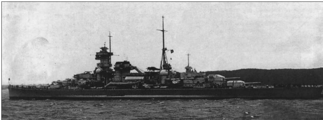
Тяжелый крейсер «Адмирал Хиппер» на ходовых испытаниях, лето 1939 г. Дымовой козырек на трубе еще не установлен, а форштевень - прямой. После окончания испытаний на трубу установили козырек и заменили форштевень. Сдаточные испытания крейсер проходил с ноября 1939 г. по январь 1940 г.
