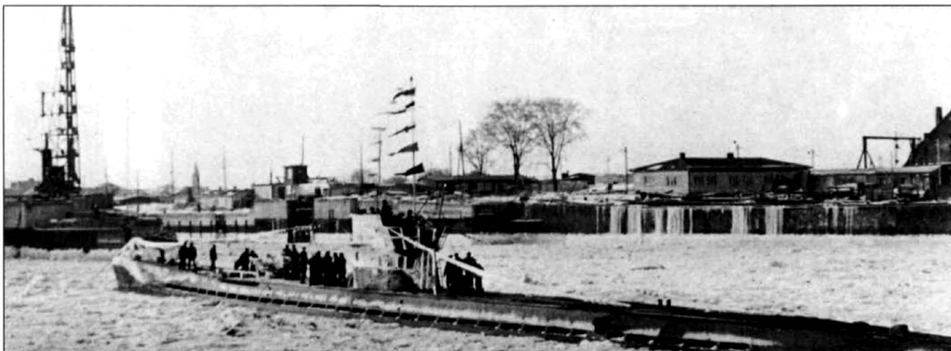
Покрытая льдом, первая лодка серии IXA входит в Вильгельмсгафен в феврале 1940 г. U-37 показана здесь с восемью победными флагами, она стала шестой среди самых удачливых лодок войны, потопив более 50 транспортов, пока не была выведена из ряда действующих в мае 1941 г. Ранние лодки IX серии можно опознать по небольшому расширению палубы у носового орудия. Все лодки IX серии отличались непрерывной линией прямоугольных шпигатов вдоль борта. Можно также отметить выхлопной патрубок по левому борту в корме.
