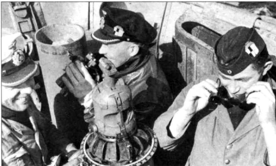
Погода немного более теплая, бинокль с UZO снят, но площадка для него еще на месте. Ее тоже можно было снять, оставив обычный открытый прицел.
